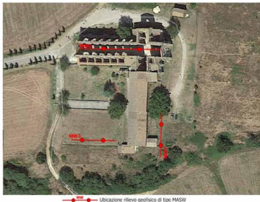
Si rileva come tra 0.0-7.2 m (sismostrati 1, 2, 3) le velocità sismiche risultino uniformi, e contenute tra 240-280 m/s, con una modesta inversione sismica al passaggio tra il sismostrato "1" ( $v_s=280$  m/s) e quello "2" ( $v_s=240$  m/s).
