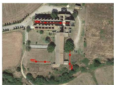
Si rileva come tra 0.0-7.2 m (sismostrati 1, 2, 3) le velocità sismiche risultino uniformi, e contenute tra 240-280 m/s, con una modesta inversione sismica al passaggio tra il sismostrato "1" (vs=280 m/s) e quello "2" (vs=240 m/s).
